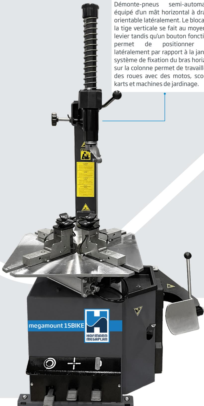
Démonte-pneus semi-automatique équipé d'un mât horizontal à drapeau orientable latéralement. Le blocage de la tige verticale se fait au moyen d'un levier tandis qu'un bouton fonctionnel permet de positionner l'outil latéralement par rapport à la jante. Le système de fixation du bras horizontal sur la colonne permet de travailler sur des roues avec des motos, scooters, karts et machines de jardinage.
