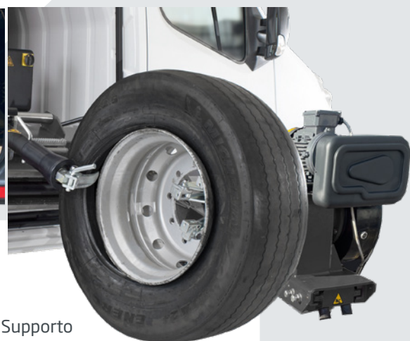
megamount 2-26T : modello con mandrino orientato a sinistra
